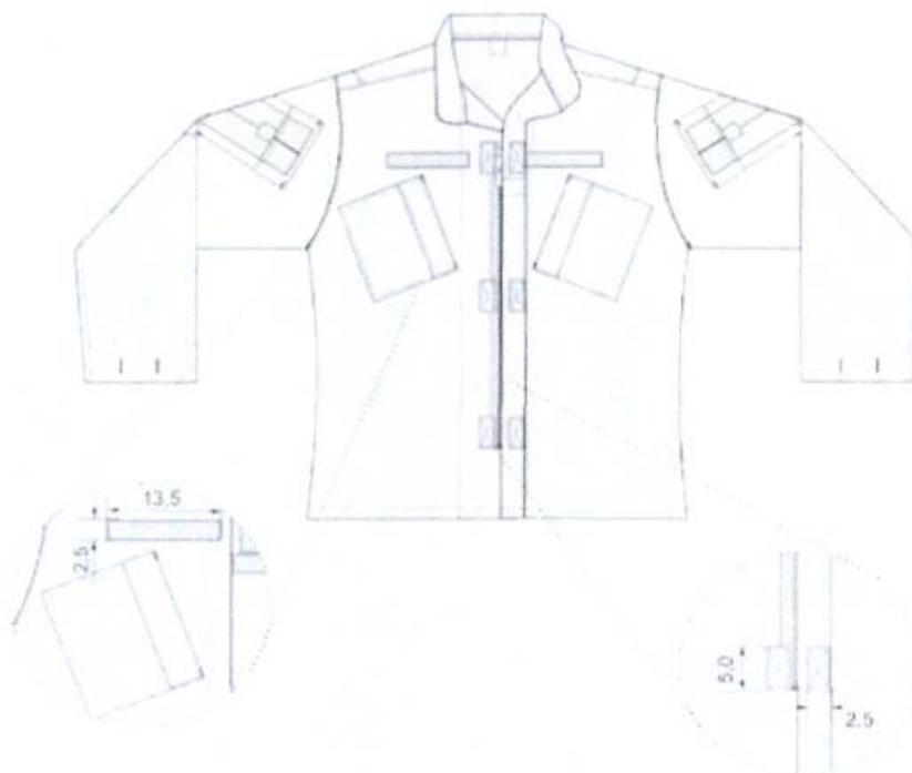
Figura 5 – Detalhes dos fechos de contato e da abertura frontal
